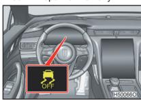
В настройках информационно-развлекательной системы автомобиля можно настроить включение и выключение функции ESC. При выключении функции загорается индикатор выключения системы ESC в комбинации приборов (см. стр. 188).
