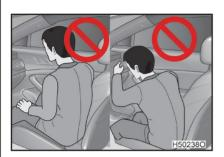
• Пожалуйста, не опирайтесь на приборную панель, переднюю стойку, боковые части крыши, двери или края сиденья, в противном случае раскрытие подушки безопасности переднего пассажира может привести к сильному удару по голове и стать причиной серьезной травмы или даже смерти (когда дети едут в машине, им следует уделять больше внимания).
