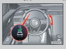
Когда система определяет, что автомобиль выезжает с полосы движения, соответствующая боковая линия становится красной и мигает, и одновременно подается предупреждающий звуковой сигнал, при этом рулевое колесо автоматически корректирует движение.
