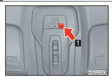
■ Нажмите кнопку как, чтобы включить заднюю лампу для чтения, коснитесь еще раз, чтобы выключить заднюю лампу для чтения.
