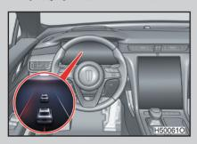
Когда система определяет, что автомобиль выезжает с полосы движения, соответствующая боковая линия становится красной и мигает, и одновременно подается предупреждающий звуковой сигнал.
