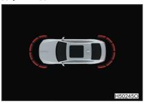
Центральный/боковой радарный датчик ближнего действия Расстояние до препятствия 1–40 см.
