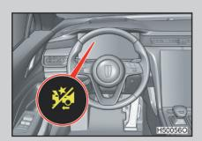
Когда система выключена, на комбинации приборов будет отображаться индикатор выключения системы предупреждения возможного столкновения.
