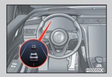
Когда система определит, что может произойти столкновение, прибор отображает тревожное сообщение и подает звуковой сигнал.
