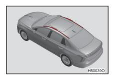
• Имеются царапины на шторной подушке безопасности, а также трещины или повреждения на защитных панелях передней стойки, средней стойки, задней стойки, потолке, ручке, лампе для чтения и других частях.
