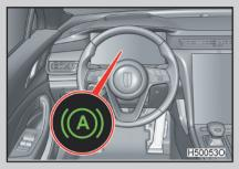
Когда функция автоматического удержания автомобиля активирована, на комбинации приборов загорается индикатор автоматического удержания автомобиля.
