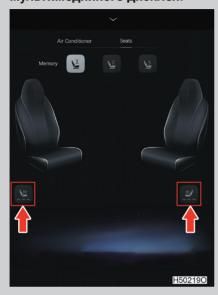
Коснитесь кнопки обогрева сидений в интерфейсе настройки сидений на мультимедийном дисплее, чтобы выбрать подходящий уровень обогрева. Можно выбрать 1–3 уровня регулировки.
