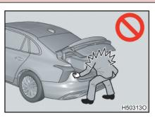
Открывание или закрывание крышки багажника на неровной поверхности сложнее, чем на ровной поверхности, поэтому остерегайтесь случайного закрытия крышки багажника во время открывания или открытия во время закрывания. Перед использованием багажника убедитесь, что крышка багажника полностью открыта и не движется.
