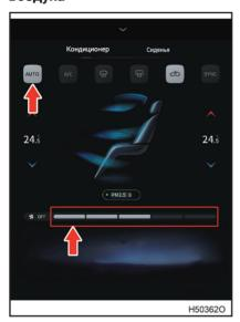
Метод 1: нажмите кнопку AUTO на интерфейсе управления кондиционером, чтобы войти в автоматический режим кондиционирования воздуха; в автоматическом режиме кондиционирования воздуха можно выбрать предпочтительный уровень.
