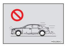
Движение по затопленным дорогам может легко привести к тому, что двигатель заглохнет, к короткому замыканию электрических компонентов, попаданию воды и т.д. Пожалуйста, не пытайтесь запустить двигатель после того, как он заглох, иначе это может привести к серьезному повреждению двигателя.
