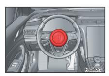
Звуковой сигнал можно включить, нажав символ звукового сигнала или окружающие его части.
