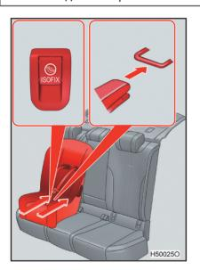
Повернув неподвижную крышку крепления внутрь, вставьте замок в специальную неподвижную скобу.
