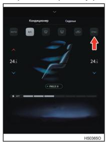
Нажмите кнопку SYNC, загорится световой индикатор, и войдите в режим управления одной температурной зоной, сторона переднего пассажира будет синхронизирована с температурой, установленной на стороне водителя.
