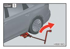
Вставьте ручку домкрата в отверстие домкрата, затем совместите ключ для колес с рукояткой домкрата, поверните его и поднимите автомобиль так, чтобы колеса немного оторвались от земли.
