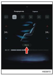
Система имеет три режима работы, и по умолчанию используется автоматический режим. Нажмите кнопку РМ2.5 на рабочем интерфейсе один раз, чтобы войти в режим немедленной очистки, и нажмите кнопку еще раз, чтобы войти в режим мониторинга.
