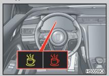
Когда система определяет, что водитель, вероятно, находится в несколько усталом состоянии, на приборной панели загорается желтый индикатор и подается звуковое и текстовое напоминание.
