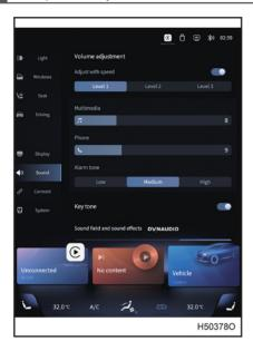
1 Регулирование громкости Регулировка в зависимости от скорости автомобиля: для настройки включения/выключения изменения громкости в зависимости от скорости и ее чувствительности.
