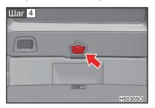
Откройте люк аварийной разблокировки на крышке багажника.
