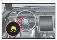
Если автомобиль заносит или ведущие колеса пробуксовывают, индикатор мигает, указывая на работу TCS/ESC.
