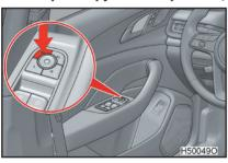
Если зеркало заднего вида запотело, нажмите кнопку обогрева наружного зеркала заднего вида; при повторном нажатии кнопки обогрев отключается.
