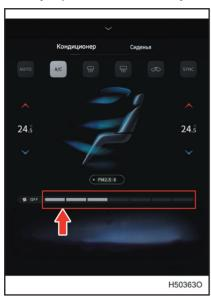
Метод 1: коснитесь панели настройки потока воздуха в интерфейсе управления кондиционером, чтобы отрегулировать поток воздуха системы кондиционирования автомобиля с уровня 1 до уровня 7.
